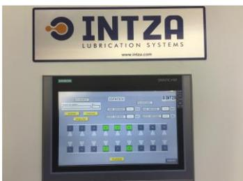
En la nueva generación de sistemas de lubricación para prensas de **Intza Lubrication Systems** todos los parámetros del patrón se controlan desde un HMI o una pantalla remota (no hay que ajustar en máquina). Es un paso hacia la conectividad total entre los componentes de las máquinas y el control central, y por tanto hacia la Industria 4.0 o “internet of things”.
