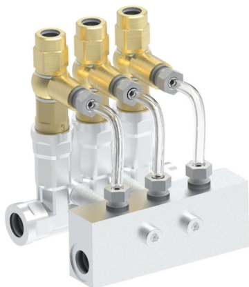
Tamaño B 0,01 - 0,03 - 0,06 - 0,10 - 0,16 cm 3 /impulso Entrada aire G1/8 Entrada aceite M10x1 Salidas aire-aceite M8x1
