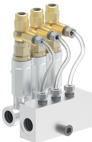
Tamaño C 0,1 - 0,2 - 0,4 - 0,6 cm 3 /impulso Entrada aire G1/4 Entrada aceite M12x1 Salidas aire-aceite M8x1
